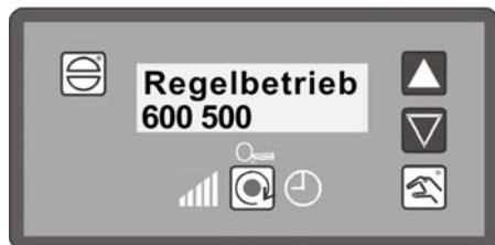
Fig. 4-2 Anzeige bei externem Leistungsregler
