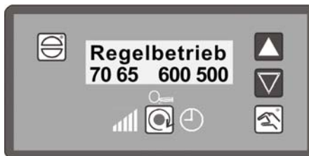
Fig. 4-3 Anzeige im Automatikbetrieb
