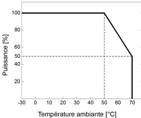
Fig. 3 Réduction de la puissance en fonction de la température ambiante
