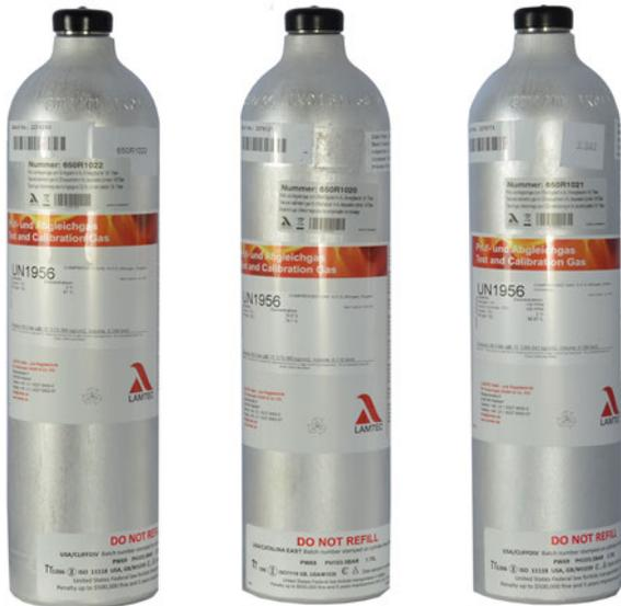
Fig. 2 Prüf- und Abgleichgasflaschen (Einwegflaschen)
