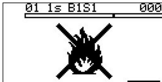
Fig. 6-4 Vista com chama DESLIGADA
