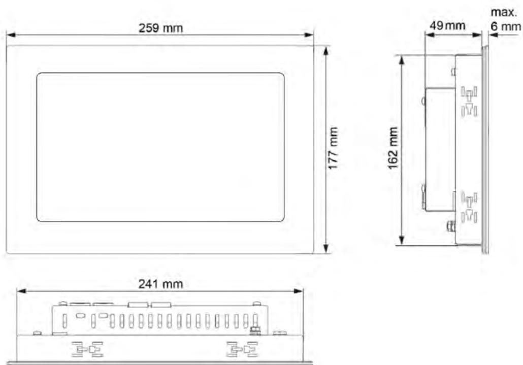
Fig. 3 Schéma coté GUI610
