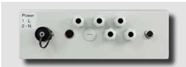
Anschlüsse LT4 an Unterseite.
