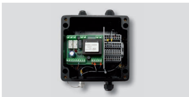
FN30-20 (230 V) CA / FN30-30 (115 V) CA dans le boîtier de raccordement avec relais d'édition 230 V CA / 115 V CA.
