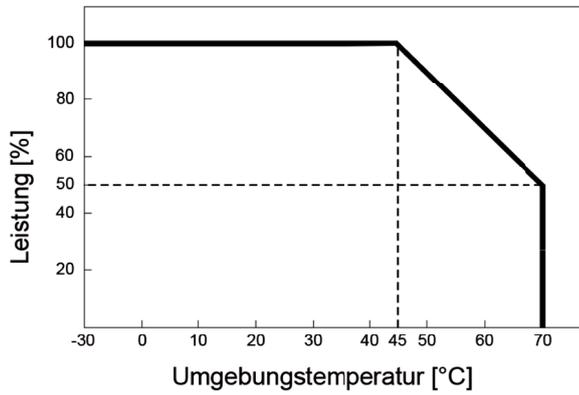
Fig. 3 Leistungsreduktion in Abhängigkeit von der Umgebungstemperatur
