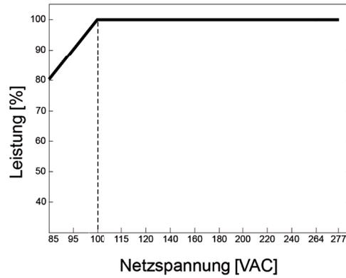
Fig. 4 Leistungsreduktion in Abhängigkeit von der Netzspannung
