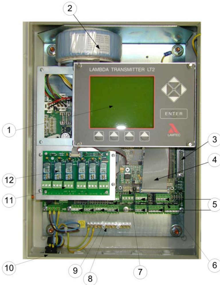
Fig. 4-1 Sterownik Lambda LT2 w stalowej obudowie naściennej typ 657R1025 z pulpitem operatorskim i wyświetlaczem typ 657R0831
