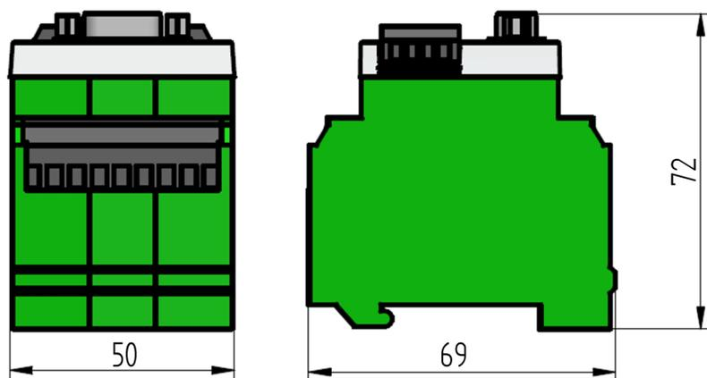
Fig. 1 Abmessungen PBM100
