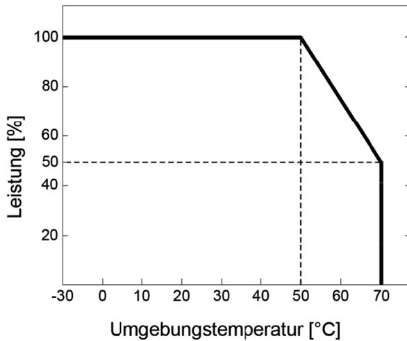
Fig. 3 Leistungsreduktion in Abhängigkeit von der Umgebungstemperatur
