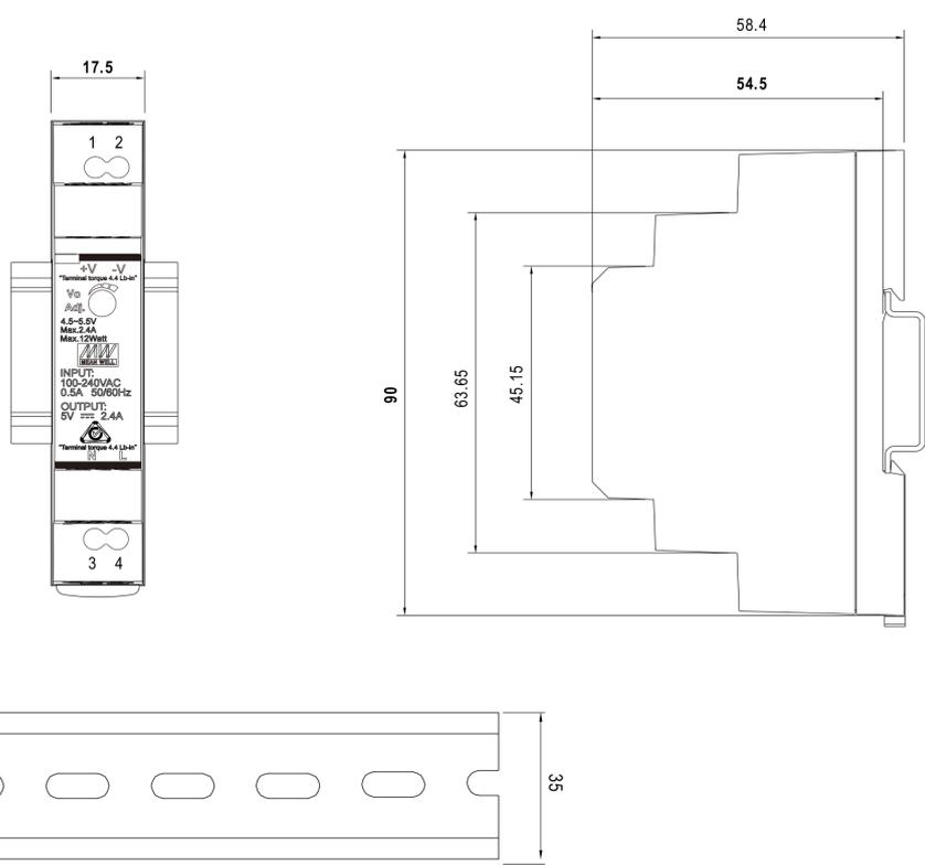
Fig. 2 Dimension bloc d'alimentation PSU2415
