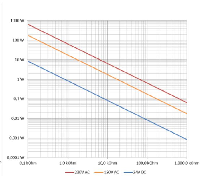
Fig. 5 Leistung des Zusatzwiderstandes bei eingeschaltetem Ausgang
