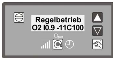
Fig. 7-2 Anzeige bei CO-Regelung
