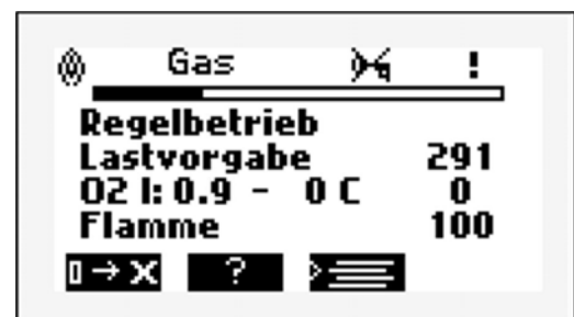
Fig. 7-4 Anzeige bei CO-Regelung
