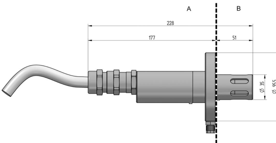
Fig. 2 Maßzeichnung Lambda Sonde LS2-Ex (Maßeinheit in mm)
