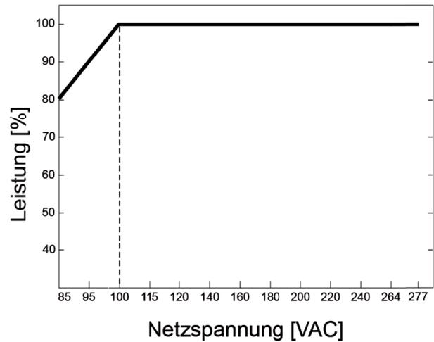
Fig. 4 Leistungsreduktion in Abhängigkeit von der Netzspannung
