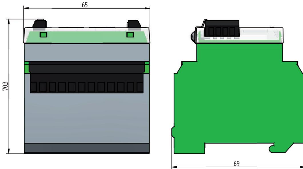
Fig. 1 Abmessungen CMS/EBM412
