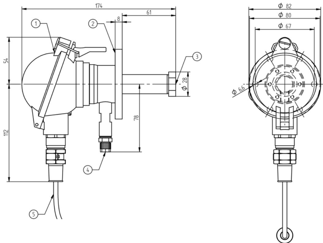
Fig. 2 Lambda Sonde LS2-HT (Maße in mm)
