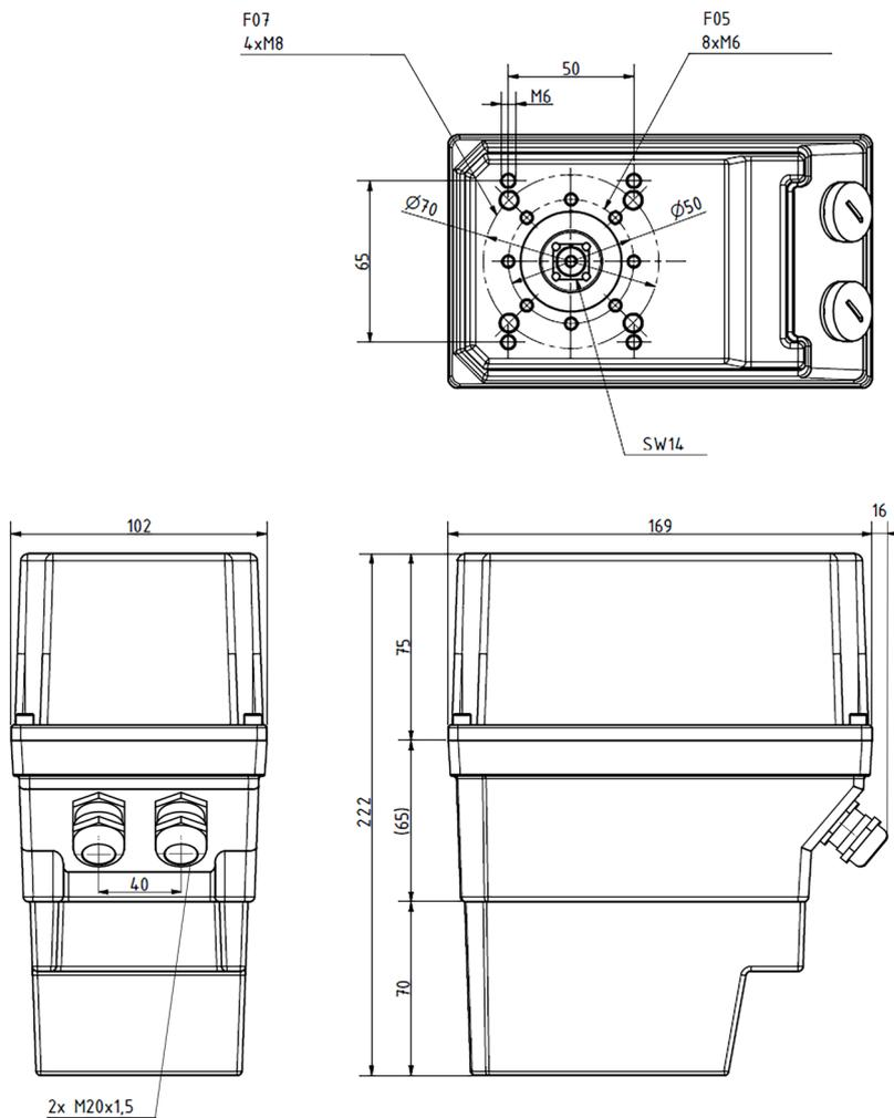
Fig. 2 Maßzeichnung Stellantrieb 60 Nm mit Kabeleinführung und Kabelverschraubung (Maße in mm)
