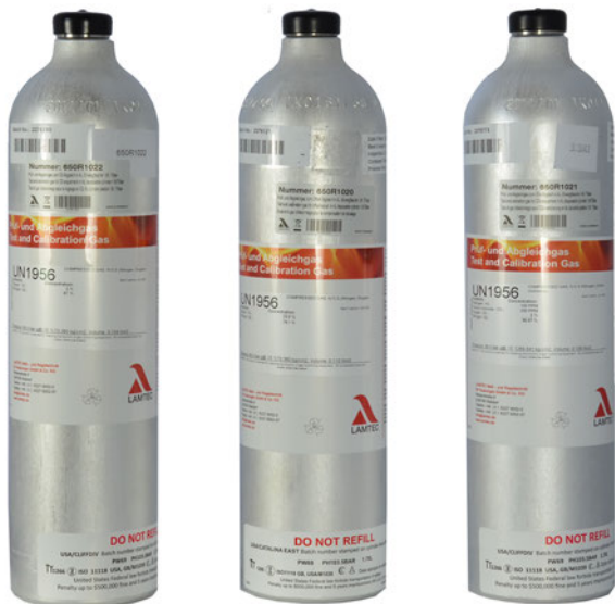
Fig. 2 Prüf- und Abgleichgasflaschen (Einwegflaschen)
